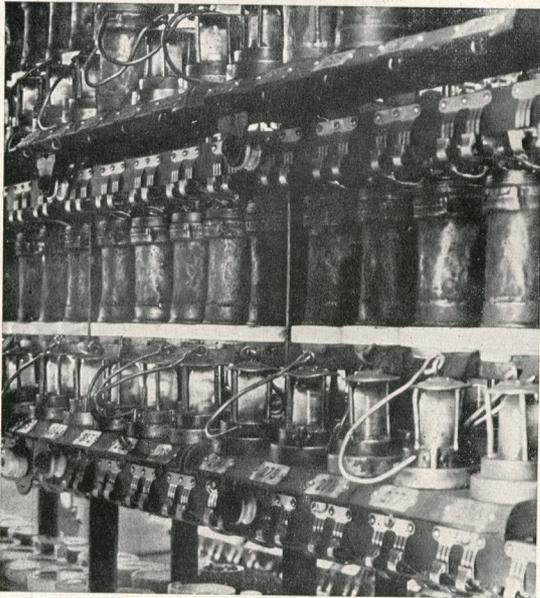
Lampes électriques des mineurs, en charge.
